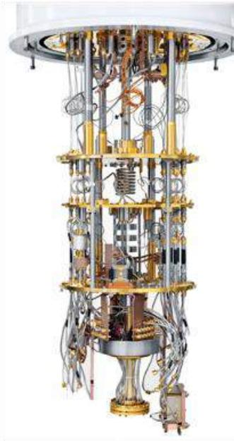
Réfrigérateur à dilution pour calculateur quantique
